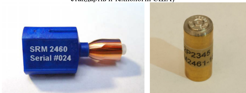
Рис. 2. Стандартна куля NIST SRM 2460, встановлена на синій заглушці (ліворуч) та прототип стандартної гільзи SRM 2461 (праворуч) (Національний інститут стандартів и технологій США).
