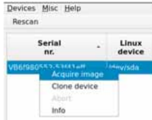
Рис. 2. Фрагмент вікна ПЗ «Guymager» з вибором дій щодо обраного носія інформації, що викликається правим кліком манипулятора «мишка»
