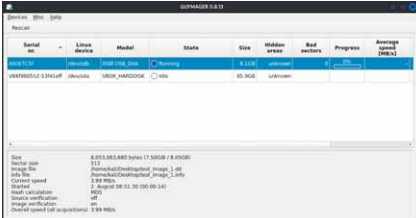
Рис. 4. Вікно ПЗ «Guymager» з відображенням процесу створення побітової копії носія інформації
